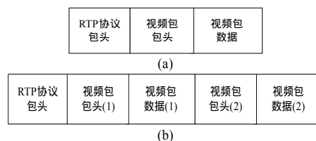
图 1 RTP 组包的 MPEG-4 视频码流封装
