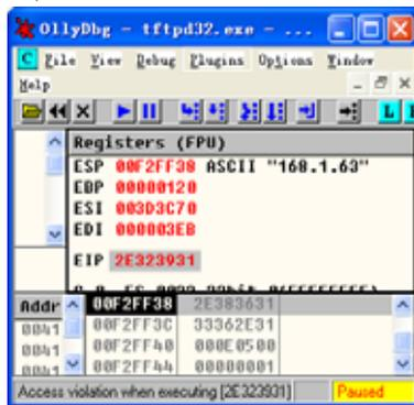
图 7 TFTP D32 版本 2.84 的漏洞调试图
