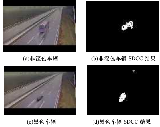
图3 基于颜色相关性的阴影检测结果
