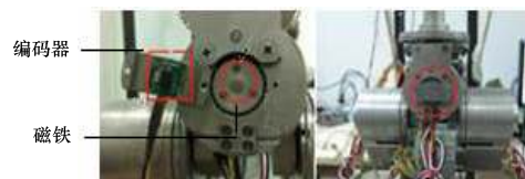
图12 位置传感器安装示意图
