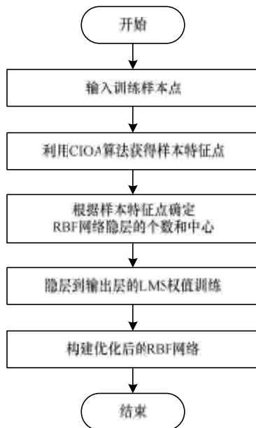
图4 CIOA 优化 RBF 网络算法流程
