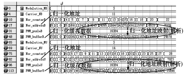
图 8 调制波归一化地址、缓存数据仿真图
