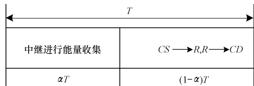
图2 基于时间分配的全双工能量收集示意图
