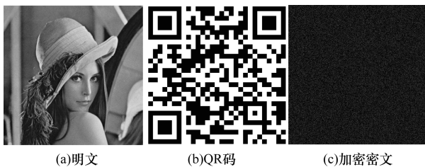
图 5 基于两级 Gyrator 变换的图像加密过程
