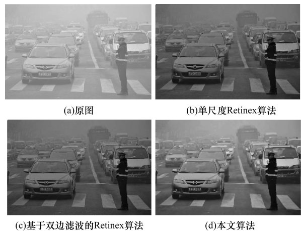
图 7 不同算法对雾霾图像 traffic 的处理结果
