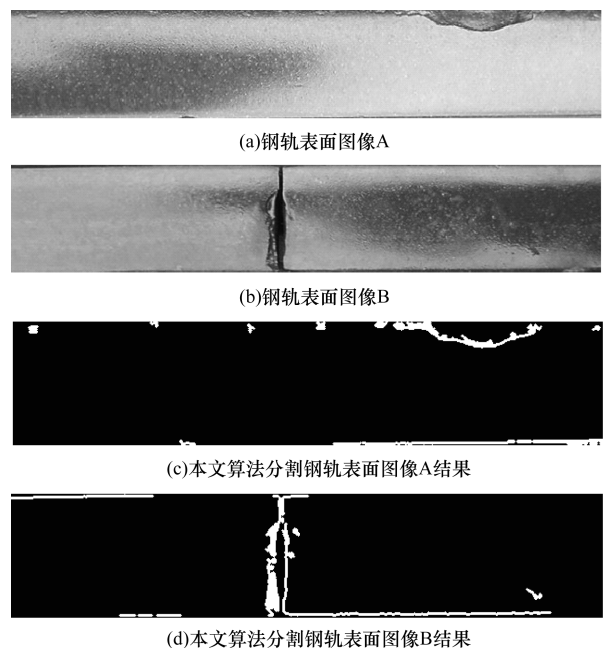
图 8 钢轨表面图像分割结果
