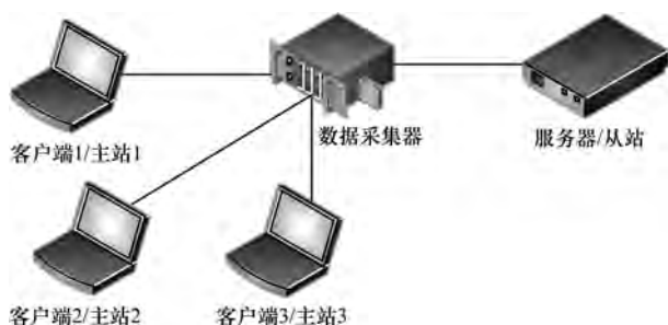
图2 Modbus/TCP 通信拓扑结构
