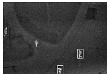
图6 OTCBVS 红外数据集上的行人检测结果 1 Fig. 6 Pedestrian detection results 1 on the OTCBVS dataset of infrared images
