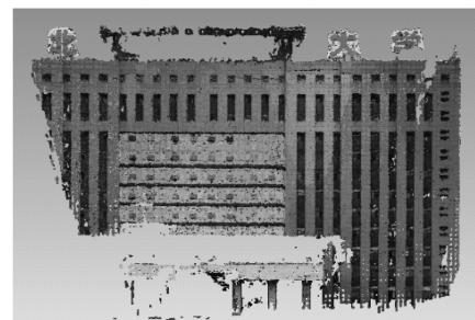
(b)球面投影方法的点云数据与纹理影像配准效果
