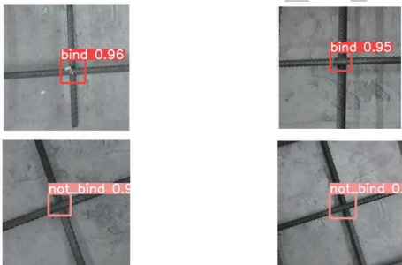
图 19 钢筋节点绑扎状态检测效果展示
