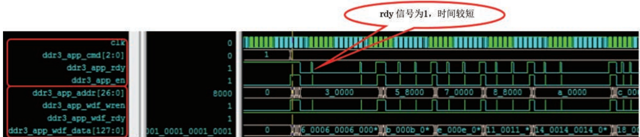
(a)优化前(一行写1个数据)DDR3 SDRAM写数据仿真时序图
