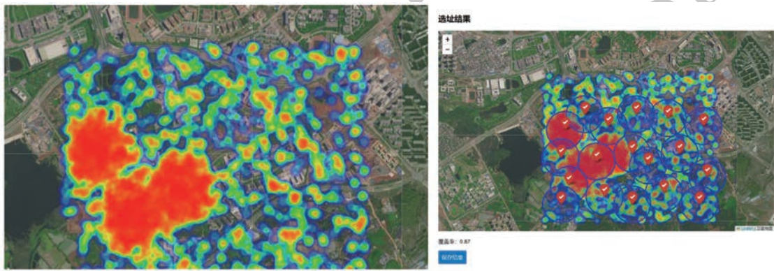
图 2 某高校用户分布热力图和基站选址结果
